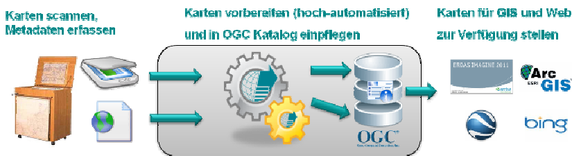
Abbildung 2: GEOSYSTEMS Konzept zur web- und GIS-fähigen Aufbereitung von Archivkarten. Die Nutzung steht für alle im OGC-Umfeld arbeitenden GIS-Systemen bzw. Web-Anwendungen zur Verfügung (die genannten Anwendungen sind Beispiele)
